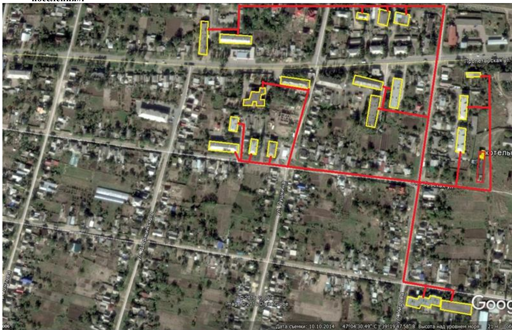
Рисунок 1. – Зона теплоснабжения Котельной №1 после реконструкции с. Кагальник Азовский р-н, Ростовская обл.
