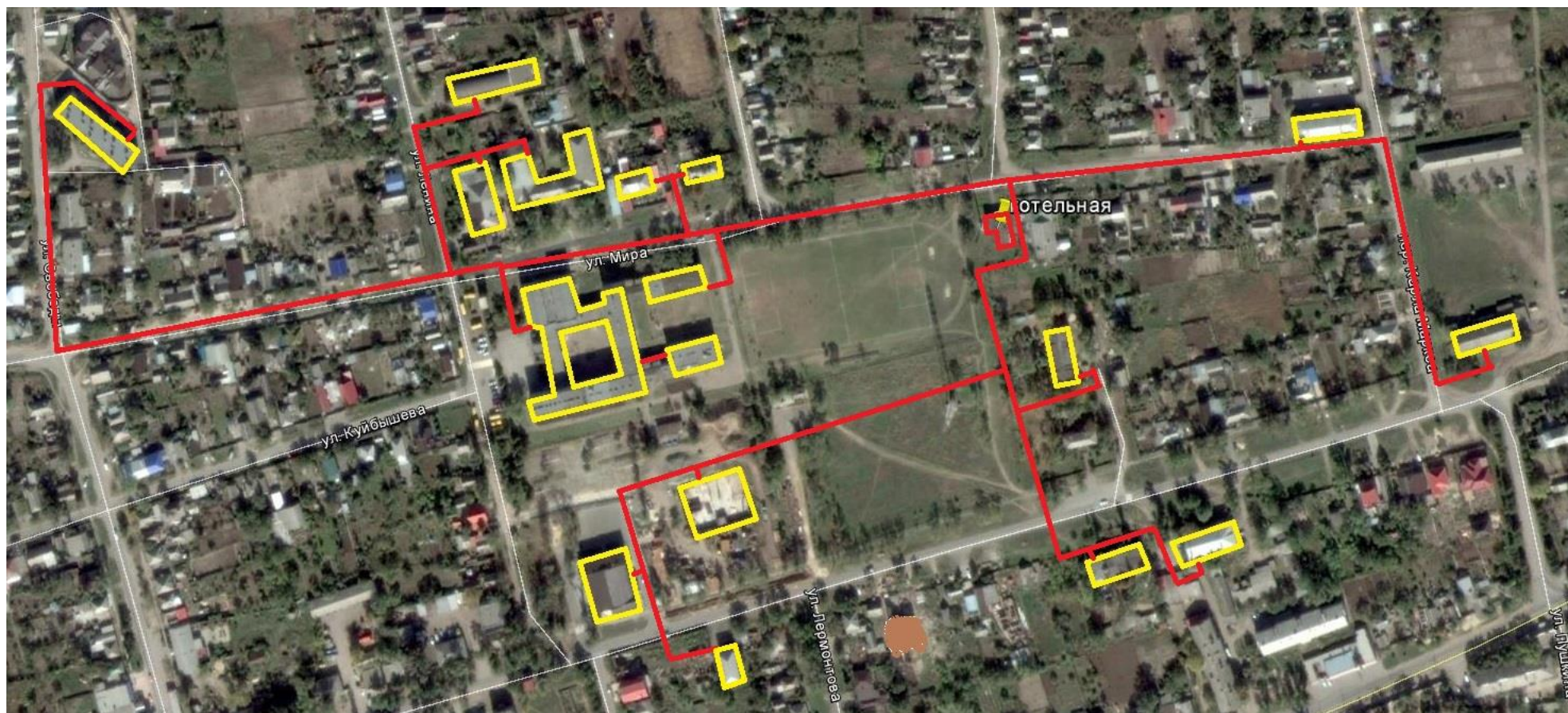
Рисунок 2. – Зона теплоснабжения Котельной №2 после реконструкции с. Кагальник Азовский р-н, Ростовская обл.
